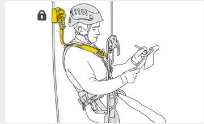
Функция блокировки устройства позволяет зафиксировать устройство и уменьшить глубину падения.
