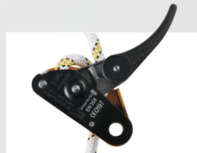
Все самостраховки GRILLON оборудованы рукояткой, позволяющей использовать самостраховку одним концом. Устройство при этом присоединяется к брюшной точке крепления на страховочной системе. С помощью рукоятки пользователь освобождает кулачковый механизм, чтобы скорректировать свое положение. Свободный конец верёвки при этом необходимо удерживать рукой.
