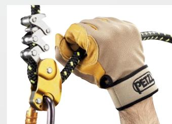
Ролик на герметичном подшипнике позволяет легко выбирать слабины веревки.
