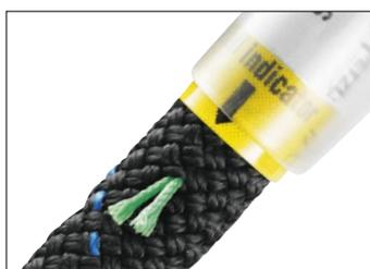
Индикатор фактора рывка: исчезновение зелёных нитей означает, что самостраховка сработала при падении с большим фактором рывка (при неправильном использовании).
