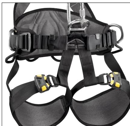
Поясный ремень и ножные обхваты AVAO достаточно широкие, чтобы уменьшить давление и обеспечить эффективную поддержку. Эти две зоны снабжены подкладкой из перфорированного пеноматериала для максимального комфорта и хорошей вентиляции. Такая конструкция также упрощает надевание страховочной системы.
