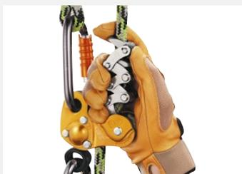
Управление устройством осуществляется с помощью лёгкого нажатия на спусковой крючок. Когда крючок не нагружен, устройство схватывает верёвку. Изменяя силу нажатия на крючок, можно контролировать скорость спуска.
