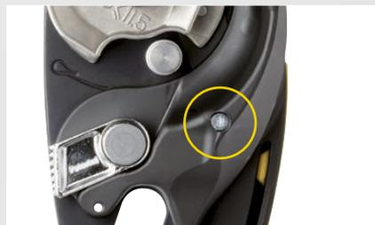
Предохранительная защёлка уменьшает риск несчастного случая из-за неправильной заправки верёвки в устройство. Блокирующий винт на поворотной боковой пластине позволяет использовать I'D S в качестве составной части спасательного набора.
