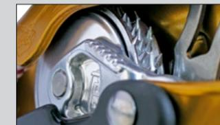
При нормальном использовании, блокирующее колесико просто катится по веревке (вертикальной или наклонной), следуя за движением пользователя. В случае падения или резкого увеличения скорости (скольжение, неконтролируемый спуск), колесико блокируется на веревке и останавливает падение.
