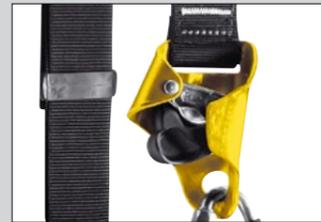
Обвязки для сложного доступа имеют встроенный брюшной верёвочный зажим CROLL. Регулировка плечевых ремней необходима, в первую очередь, для позиционирования CROLL. Карабин, соединяющий плечевые ремни с поясом, имеет планку препятствующую вращению карабина.
