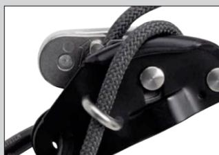
Самоблокирующееся устройство позволяет пользователю контролировать и останавливать спуск в любой момент, а также быстро перемещаться по горизонтали. В случае падения устройство проскальзывает по верёвке ограничивая нагрузки на тело пользователя.
