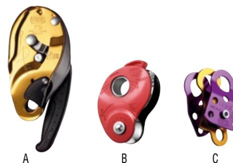
**A G'D S:** универсальное самоблокирующееся страховочно-спусковое устройство с функцией «антипаник»; обеспечивает простой контроль скорости спуска. **B MINI TRAXION:** компактный блок-ролик; легко устанавливается на веревке, блокирует обратный ход веревки в полиспастных системах. **C GEMINI:** двойной прусик-блок с алюминиевыми щечками и ролике на шарикоподшипниках; для полиспастов.
