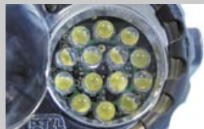
Модуль из 14 светодиодов
