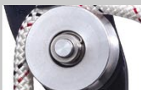
Алюм-вый ролик установленный на закрытом шарикоподшипнике
